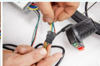
В зависимости от типа комплекта, подключите к соответствующим разъёмам контроллера ручку газа и управляющий велокомпьютер либо ручку газа с LED-индикацией.
