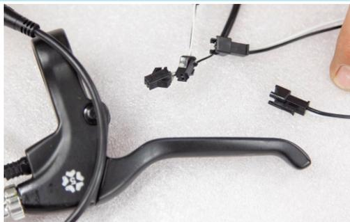
Подключите кабели концевиков ручек тормоза красным коннектором к ручке. К соответствующим разъёмам от контроллера ручки можно подключить в любом порядке (без деления на левую и правую).
