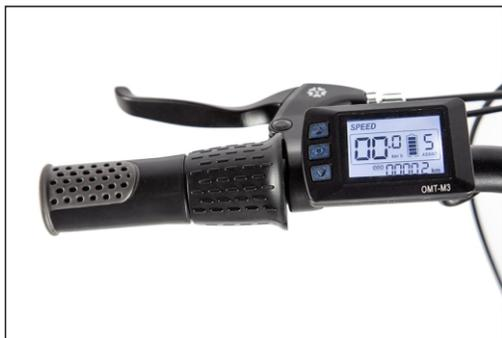
Протестируйте работу комплекта, нажав кнопку включения на ручке газа с LED-индикацией или на вашем управляющем велокомпьютере.
