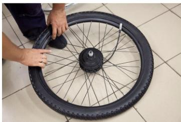
Снимите колесо с вашего велосипеда (переднее или заднее - в зависимости от типа комплекта) и перебортируйте камеру с крышкой на мотор-колесо Eltreco.
