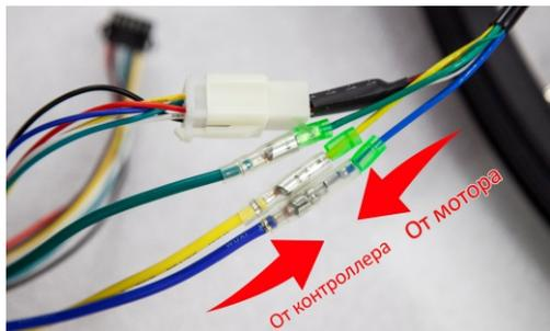
После подключения коннекторов, соедините остальные три провода от мотор-колеса с аналогичными по цветам проводами контроллера.
