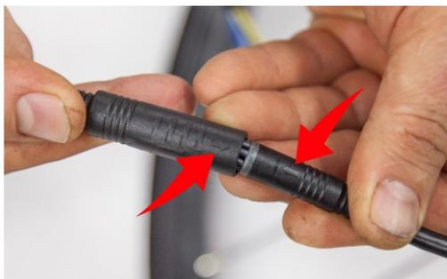
Подключите соединительный кабель к разъёму мотора. Обратите внимание на стрелки и риску, указанные на соединениях. Соедините разъёмы по стрелкам, до упора по риске.
