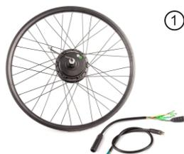
① **Электромотор Eltreco** мощностью 350W, 500W или 1000W. Моторы делятся на задние и передние, а также отличаются по напряжению (36V и 48V) и совместимостью с диаметром обода. Мотор зашпицован в крепкий двойной обод с использованием усиленных спиц, рассчитанных на вес электромотора. Диаметры ободов: 20", 26" или 27,5". Гайки и шайбы для надёжного крепления мотор-колеса прилагаются в комплекте.
