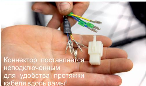
Коннектор поставляется неподключенным для удобства протяжки кабеля вдоль рамы!
