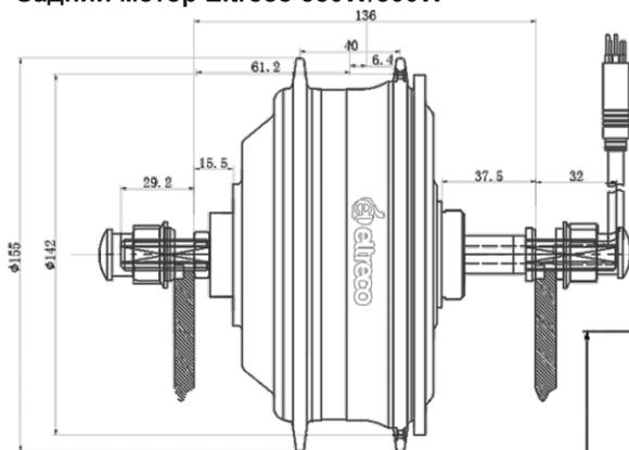
Задний мотор Eltreco 1000W
