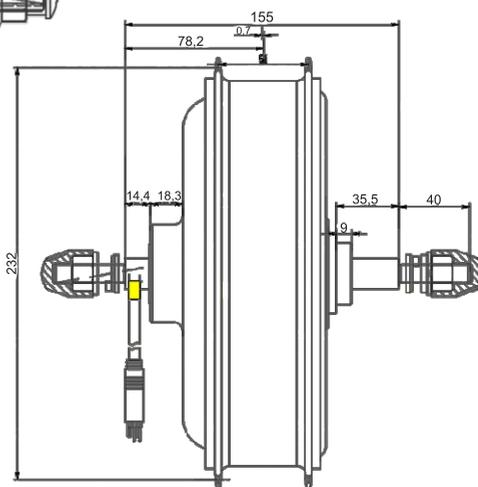
Передний мотор Eltreco 350W/500W
