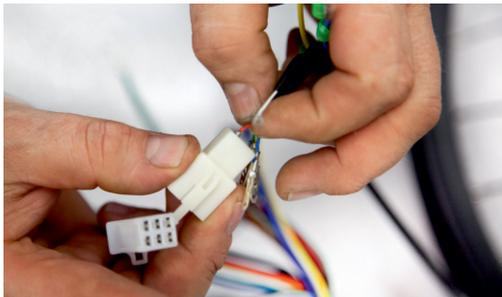
Подключите концы разноцветных проводов соединительного кабеля мотор-колеса к пластиковому коннектору. Внимательно сравните их последовательное расположение по цветам с аналогичными проводами на ответной части, идущей от контроллера. Вставляйте клеммы проводов в соответствующие отверстия коннектора с лёгким усилием до щелчка.
