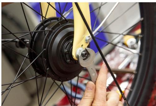
Надёжно закрепите мотор-колесо в передней или задней вилке, используя гайки и шайбы, поставляемые в комплекте. Для надёжности допустимо использование усилителей дропаутов. Особенно это актуально для мощных моторов в сочетании с алюминиевыми вилками!
