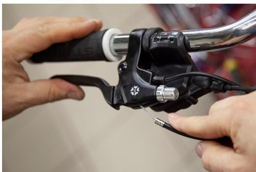
Замените **тормозные ручки** вашего велосипеда на ручки, идущие в комплекте. Они снабжены датчиками, отключающими электродвигатель. Закрепите тормозные тросики в ручках.
