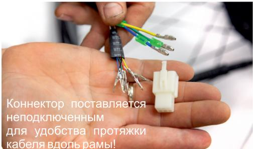
Коннектор поставляется неподключенным для удобства протяжки кабеля вдоль рамы!
