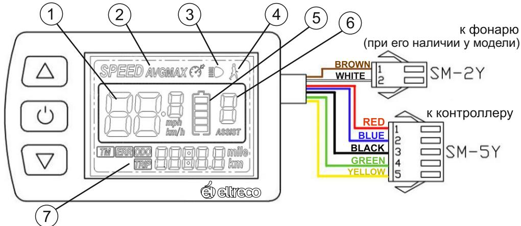
( - кнопка включения/выключения. Для активации/деактивации электромотора зажмите кнопку на 3 секунды.)
