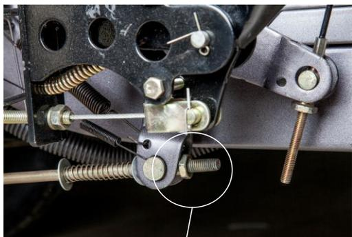
Для уменьшения свободного хода нужно вращать регулировочные гайку (см на фото) по часовой стрелке, а для увеличения свободного хода — против часовой стрелки.
