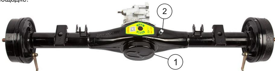
Для облегчения слива отработанной смазки из редуктора необходимо прогреть его путем поездки на ГЭТ в течении 10 - 15 мин.
